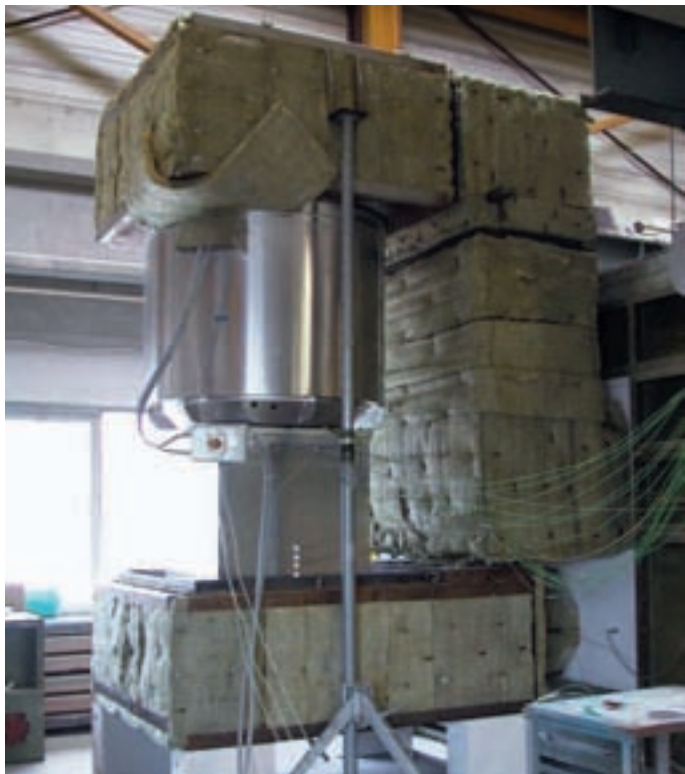
Kompletter Prüfaufbau für Entrauchungs-Dachventilatoren. Die Rauchgase werden aus dem Ofen angesaugt und über die am Ausblas angebrachte Rückführungsleitung in den Ofen zurückgeleitet.
