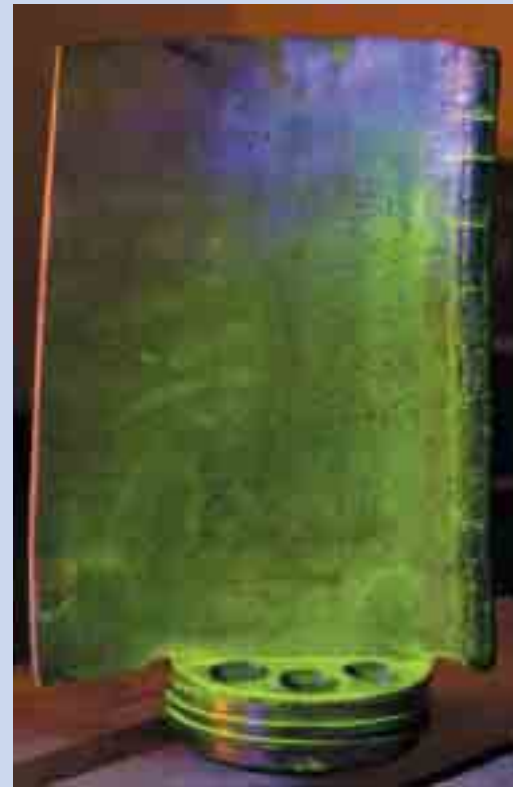
MT-Prüfung einer Laufschaufel
