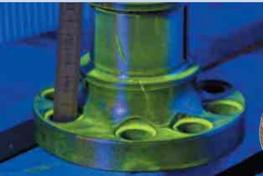
MT-Prüfung eines Holmes (Verstellwelle)
